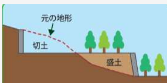
図表：盛土・切土のイメージ 出典：東京都盛土規制法パンフレット
