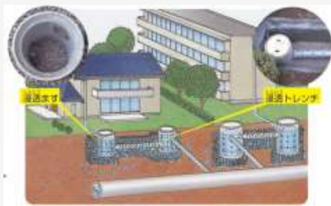
図表：浸透施設のイメージ 出典：東京都総合治水対策協議会パンフレット
